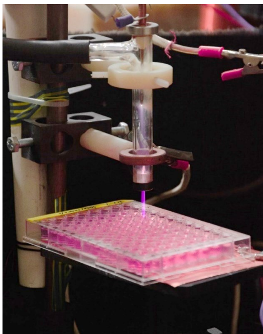
Рис. 10. Установка с газоразрядным устройством для обработки клеток ХПС.
